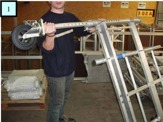
• Mettre les roues RP 200R dans les embases EC 150 IP (fig.1)
